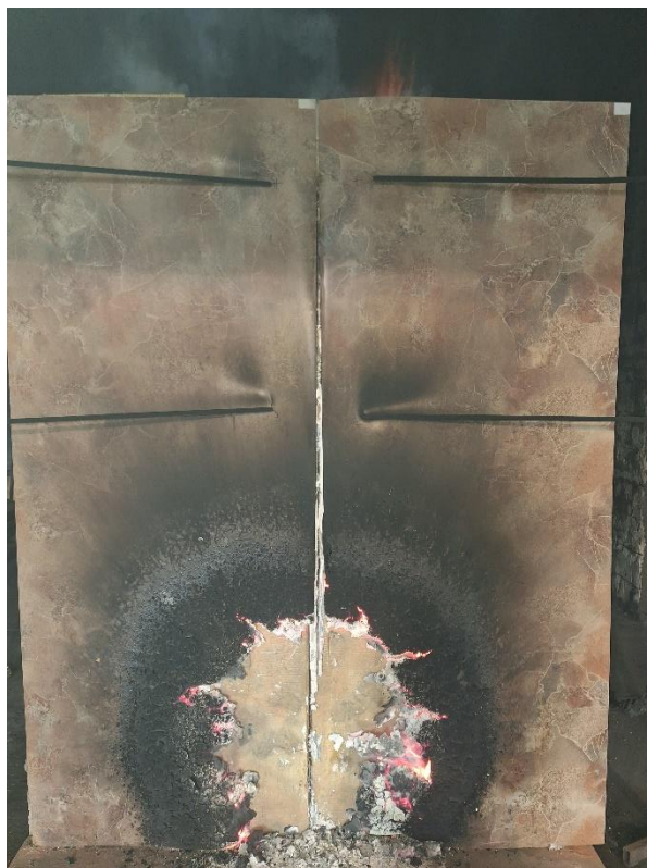
Fot. 2 Widok próbki 1 po badaniu
