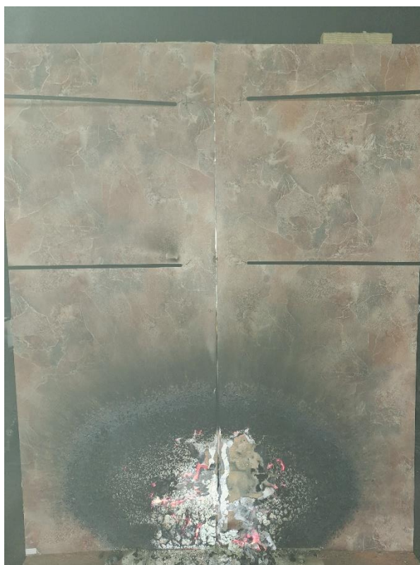
Fot. 4 Widok próbki 2 po badaniu
